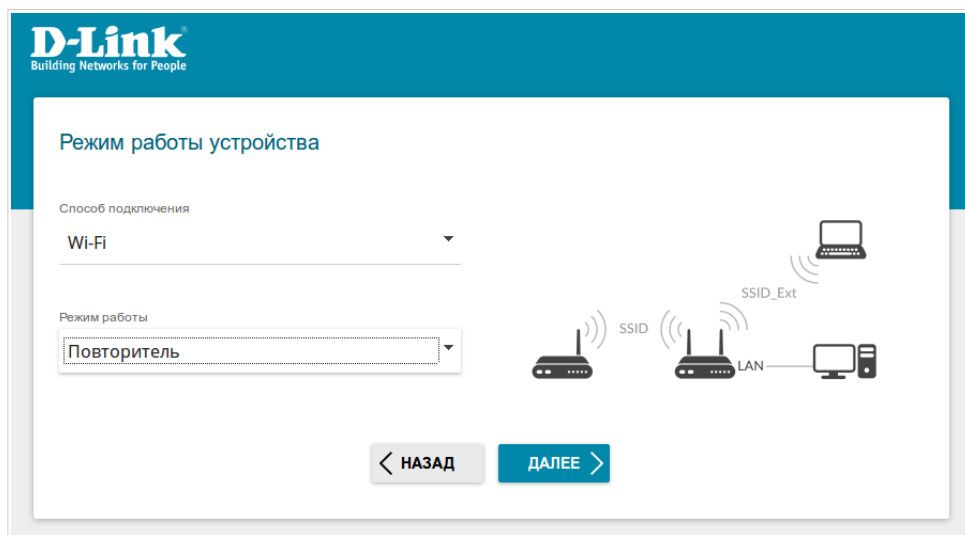
Рисунок 26. Выбор режима работы устройства. Режим Повторитель .
