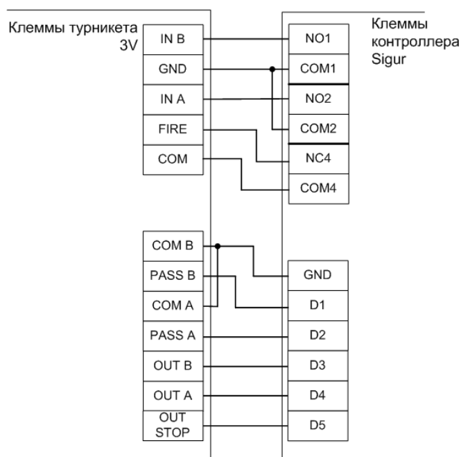
Подключение турникета 3V к контроллеру с помощью разъёмов на лицевой стороне платы управления турникета.
